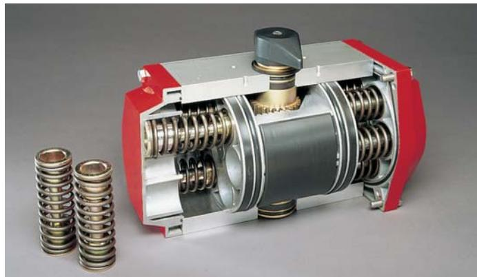
Набор возвратных пружин должен обеспечить достаточное усилие и требуемую величину хода для возврата поршней в заданное исходное положение. Различают режимы привода FC (аварийное закрытие) и FO (аварийное открытие).
