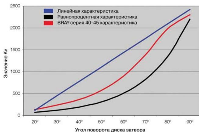
Не допускается дросселирование потока при малых углах открытия затвора, так как это может привести к кавитации. Для автоматизированного расчета коэффициента расхода  $K_v$ , контроля параметров выбранного затвора, выбора оптимального условного диаметра предназначена программа “Bray Controls Valve Sizing”, которую можно загрузить и установить с сайта компании BRAY.
